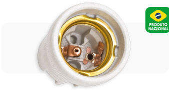
Soquete E27 1 x E27 | Máx: 100W | Ø40x45mm Porcelana Individual - 009000-99 | Granel - 00900099
