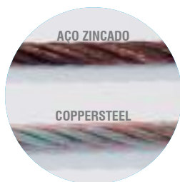
Comparação dos materiais após 10 anos cravados no solo.
